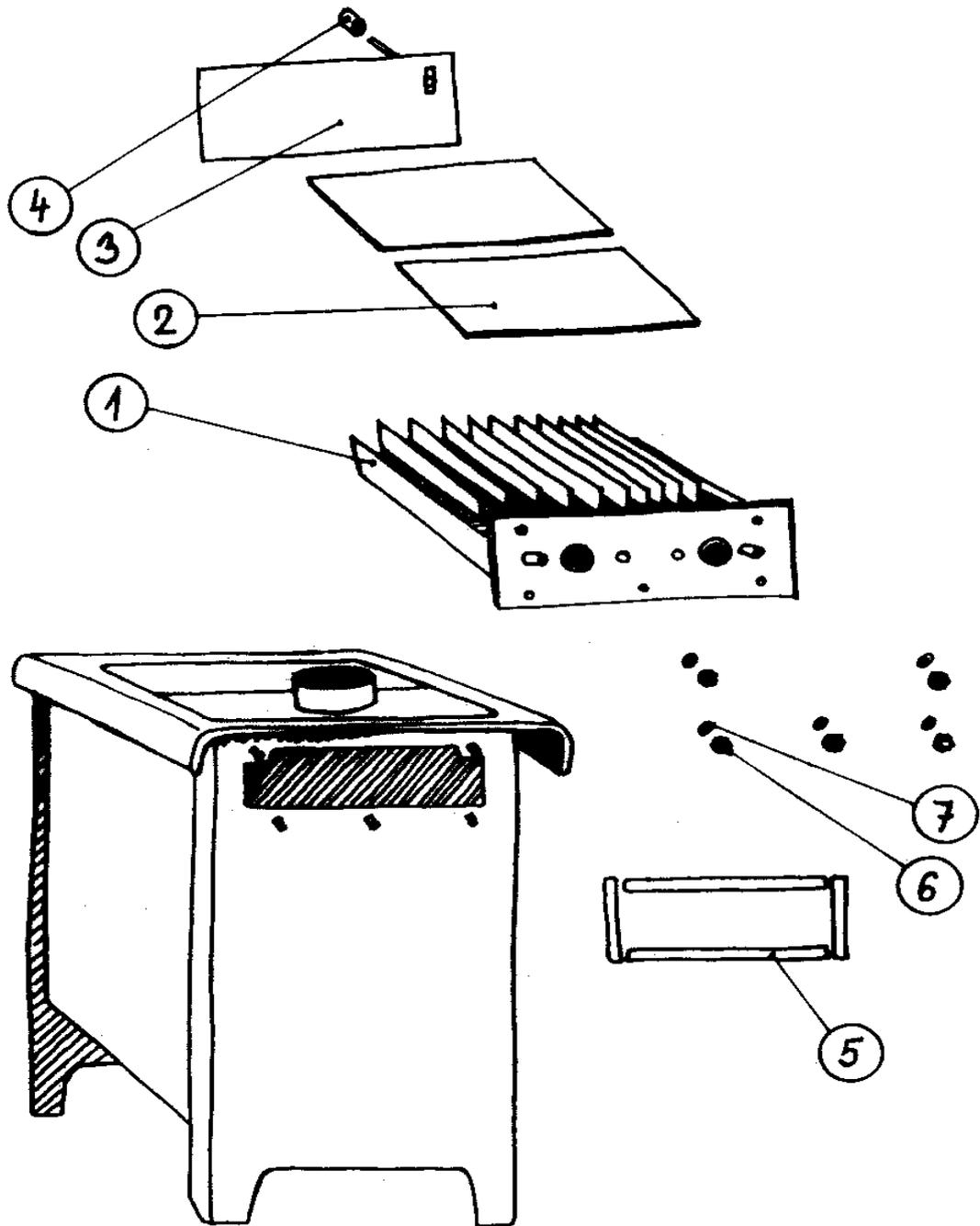
Ausführung mit dem Wärmetauscher:
